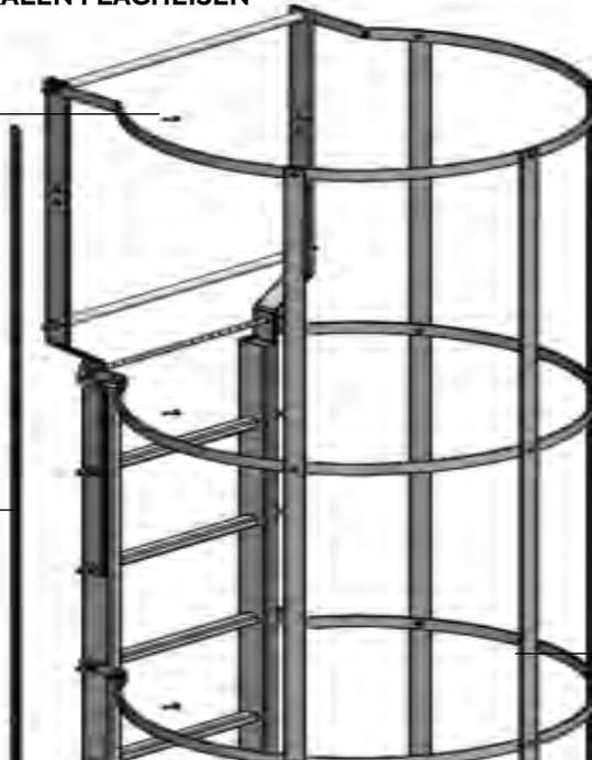
Vertikales Flacheisen mit Bohrung zur Verriegelung (x1)
