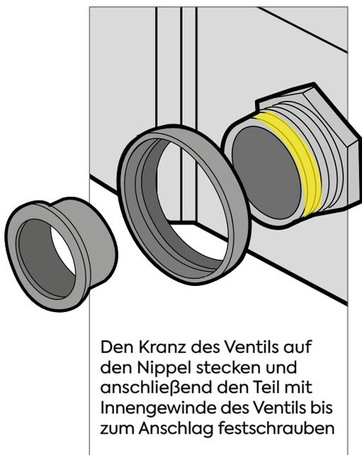
Den Kranz des Ventils auf den Nippel stecken und anschließend den Teil mit Innengewinde des Ventils bis zum Anschlag festschrauben
